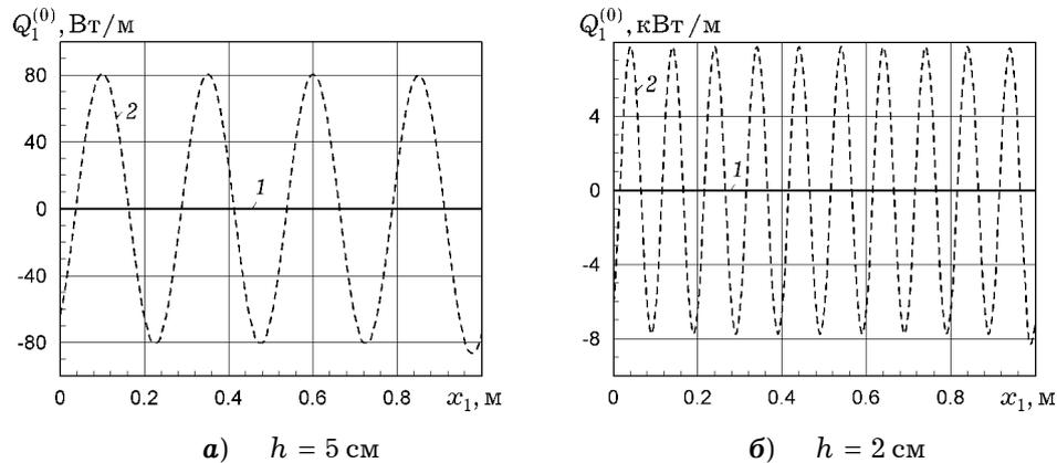
Рис. 3. Зависимость интегрального тангенциального теплового потока в КМ-пластине от координаты  $x_1$  при разной толщине конструкции.
