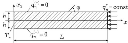
Рис. 1. Поперечное сечение прямоугольной удлиненной КМ-пластины.
