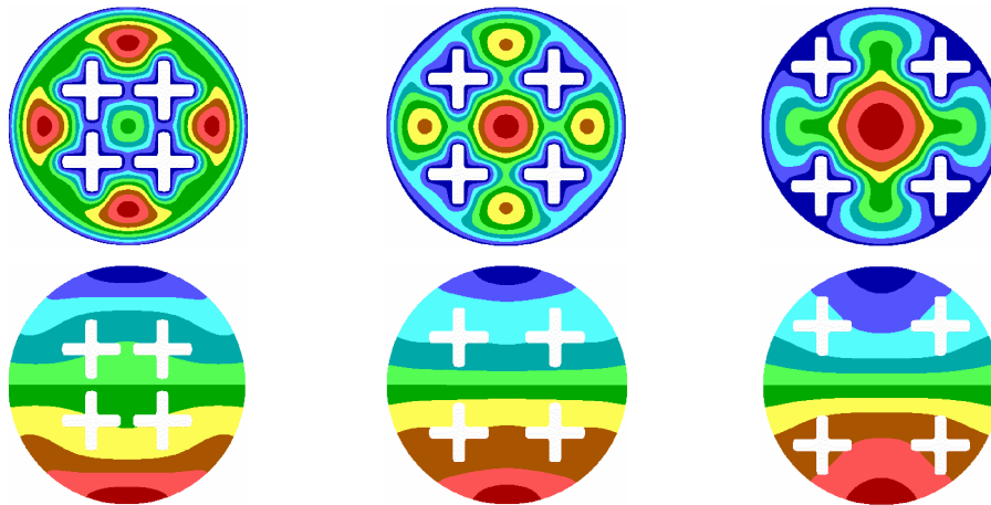
Рис. 8. Картины распределения поля скоростей (верхний ряд) и электрического потенциала (нижний ряд) при изменении формы канала и положения стержней (схема на рис. 2г).
