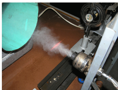
Рис. 7. Распыливание топлива и определение дисперсности распыла по лазерному методу.
