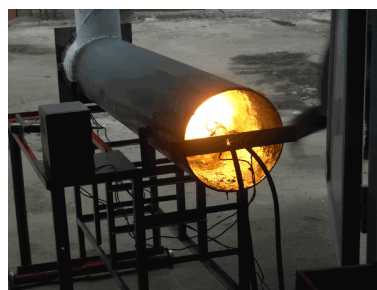
Рис. 8. Экспериментальная установка по сжиганию композиционного топлива.
